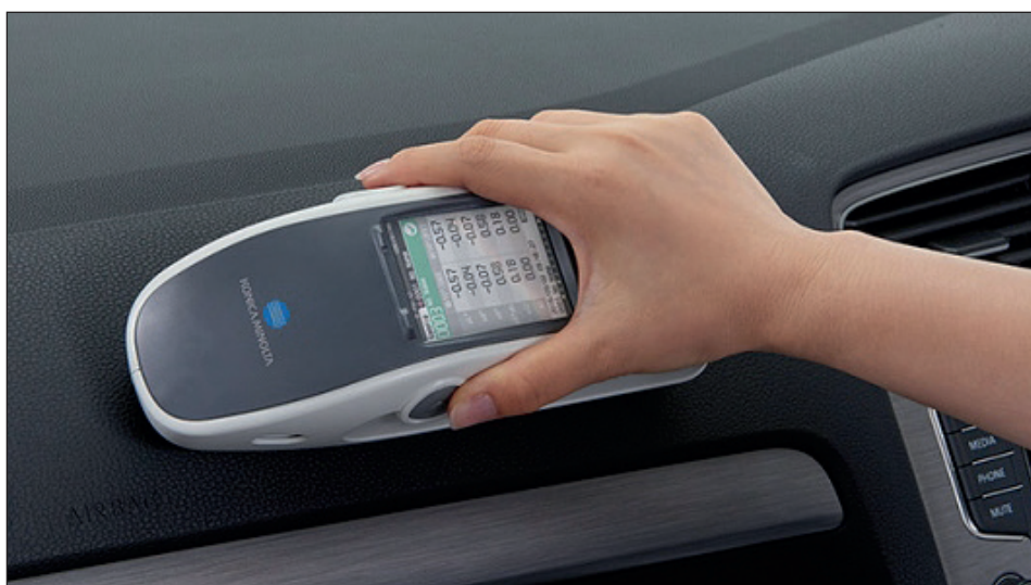
Spektrální fotometr CM-25cG s geometrií 45°:0°
