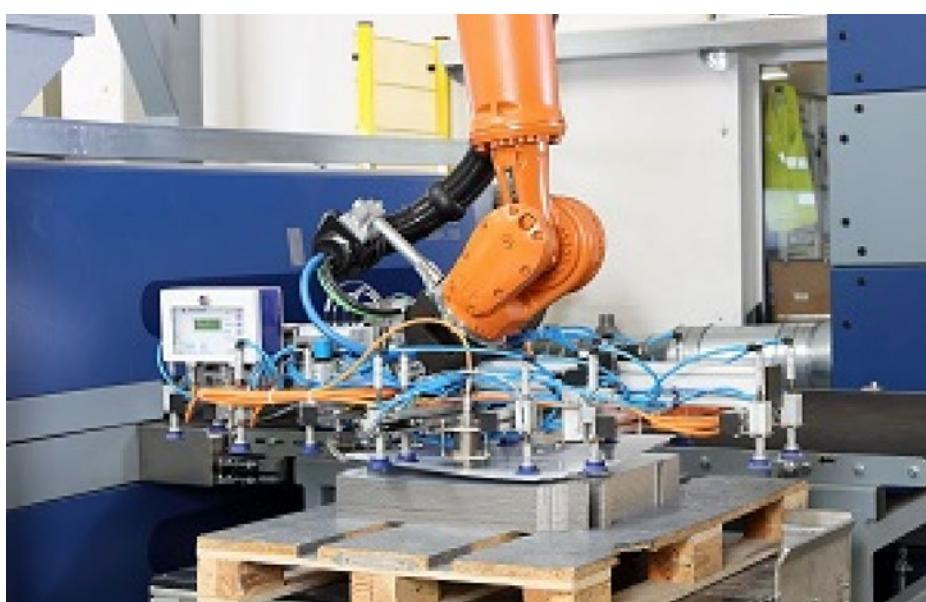
Další překážkou byla otázka vzájemného odebírá robot speciálním vakuovým chapanem spojení jednotlivých tenkých plechových dílů, vybaveným speciální technologií, které dílů umístěných na sobě. Jednotlivé plechy rá je od sebe odděluje. Dále se také provádí
