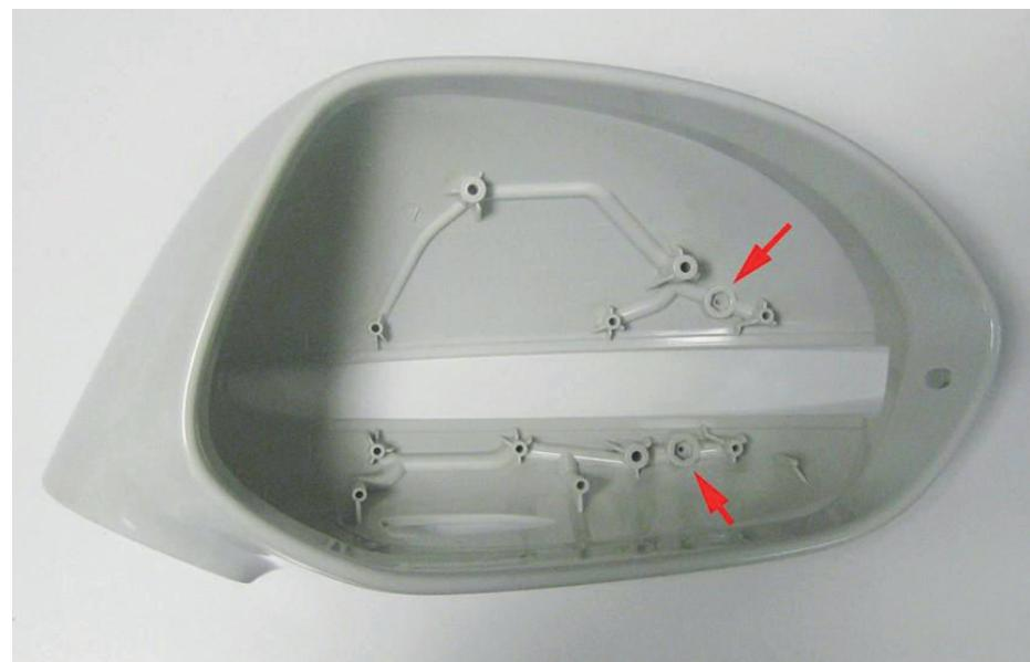
Technologie GIT umožňuje eliminovat propadliny vedením stlačeného dusíku tak, aby došlo ke stlačení polymeru ve vystupujících částech.
