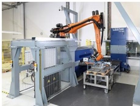
Průmyslový robot KUKA KR 120 R3900 Ultra K obsluhuje stroj při odstraňování otřepů na různých plechových dílech u výrobce kuchyňských spotřebičů v jižním Německu. Robot z rodiny KR QUANTEC zvládá různé úkoly, jako je manipulace s díly, jejich polohování, spolupráce s obráběcím strojem a následné odložení dílů. Další produkty společnosti KUKA, které se při této aplikaci využívají jsou KUKA.VisionTech, KUKA.ConveyorTech a KUKA.SafeOperation.
