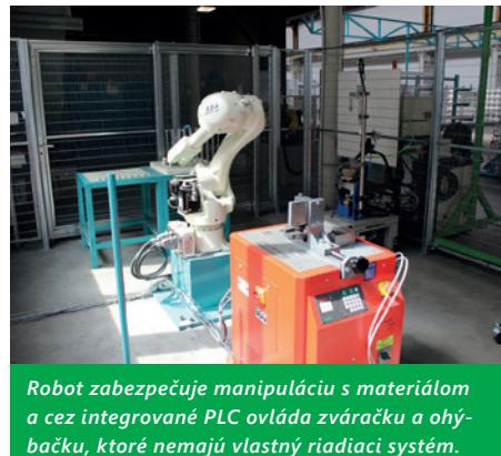
Robot zabezpečuje manipuláciu s materiálom a cez integrované PLC ovláda zváračku a ohýbačku, ktoré nemajú vlastný riadiaci systém.
