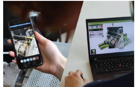
*Online podpora prostřednictvím videohovoru: stačí chytrý telefon a připojení k internetu. Obsluha stroje nebo technik údržby může také použít tablet nebo brýle rozšířené reality přímo u stroje.*
