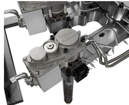
uzavíratelnými tryskami byl navržen společností HRSflow tak, aby bylo zajištěno perfektní vyvážení plnění dvou rozdílných dutin formy. Druhý systém je použit na vstřikování TPE komponentu.
