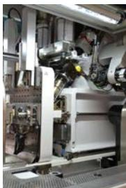
Obr. 2: MicroPower pro vícekomponentní vstřikování
