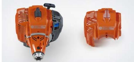
Kryt motoru křívonože - vysokoteplotní PA-GF20, odolný vůči UV záření, vynikající vzhled povrchu, možnosti barevných variant
