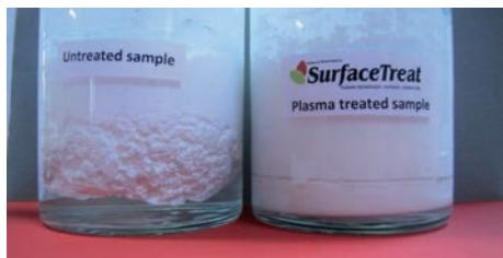
Obrázek 1: Porovnání smáčivosti neupraveného a plazmově upraveného práškového materiálu po rozmíchání ve vodě
