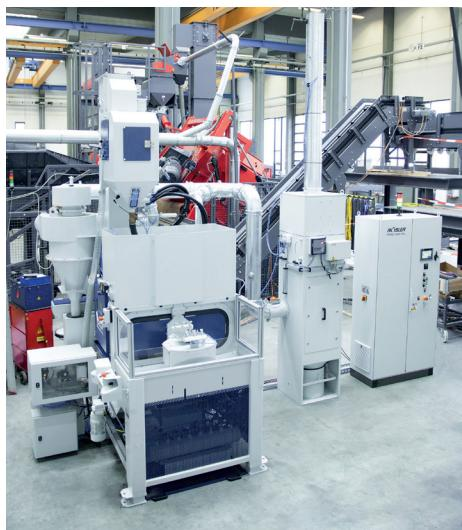
Od zpracování sypaných dílů např. na Bubnovém zařízení RMB 1.1 až po zařízení se satelity RWS 1200 nabízí odhrotování plastů řadu řešení pro téměř všechny varianty dílů
