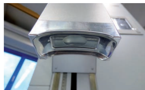
Svařovací nástroj sonotroda ukazuje na negativ svařovaného dílu.
