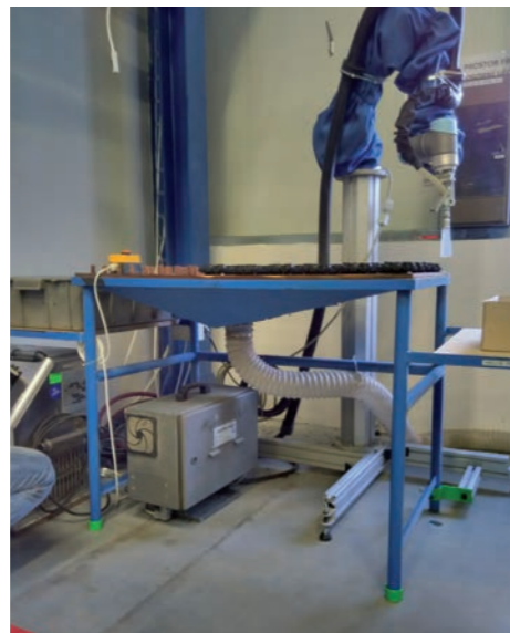
Automatizované pracoviště s ručním zakládáním výlisků
