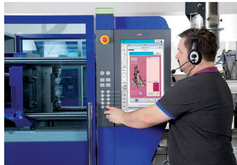
Obsluha při provádění nastavení robota pomocí řídicího systému vstřikovacího stroje UNILOG B8
