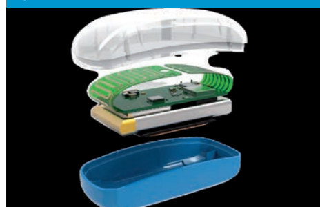
Sledovací zařízení GRETA – desky s plošnými spoji a anténa ve vnitřní části musí být během procesu výroby chráněny.
