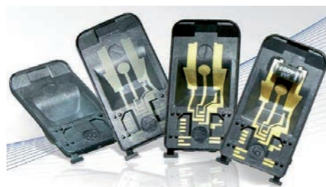
Obr. 5 PA1010 Integrované obvody LDS (LPKF GmbH)
