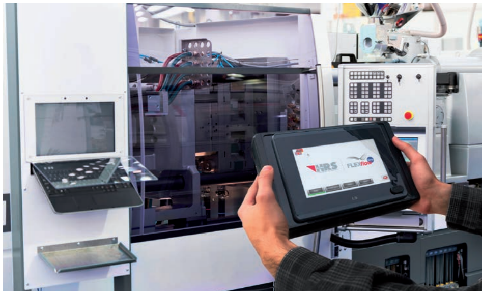
FLEXflow One – vstřikovací systém se servopohonem pro horké vtoky – využívá inteligentní externí rozhraní (External Smart Interface, ESI) pro přenos údajů o zdvihu, rychlosti a síle jehly do integrovaného modulu, který se posléze stará o ovládání pohybu jehly. © HRSflow
