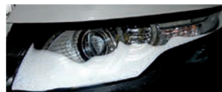
Obr. 1. Přední světlomet po kondenzační zkoušce nahore – bez aplikovaného antifog laku na vnitřní straně "skla", dole – vnější kryt s antifog lakem
