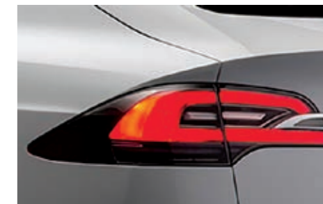
Obr.4. Zadní svítlna, jež je uvnitř vybavená odraznými bílými reflektory, které zlepšují homogennost vycházejícího světla.
