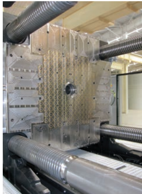
Upevňovací body, tvar desky a středící kroužek: pomocí upínacího systému Stäubli QMC122 lze upevnit na lis jakékoliv formy.
