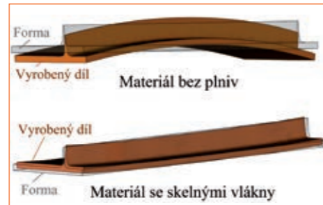
Deformace dílu s žebrem, porovnání materiálu bez sklených vláken a se skelnými vlákny
