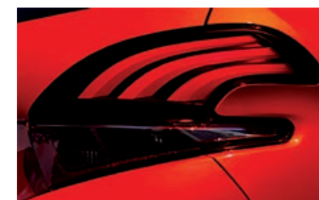
Obr. 3. Zadní svítlna, u které homogenní vzhled obrysově funkce zajišťuje filtr z difuzního typu PC materiálu
