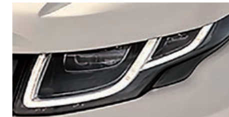
Obr. 2. Přední světlomet, kde charakteristické světelné funkce jsou tvořeny pomocí dílů vyrobených z opticky čirých plastů (PC)
