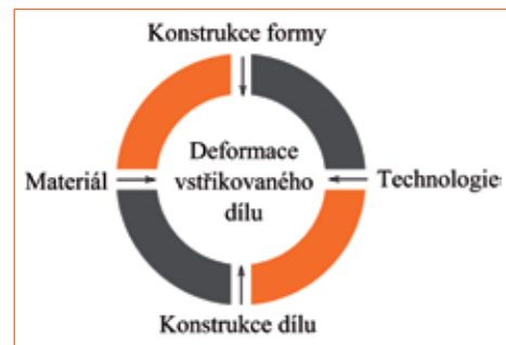
Vlivy způsobující deformace vstřikovaných dílů
