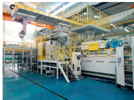
JUPITER 2 – 33000-19300 ve výrobním závodě HAITIAN NINGBO s automatickým výměnným systémem forem.
