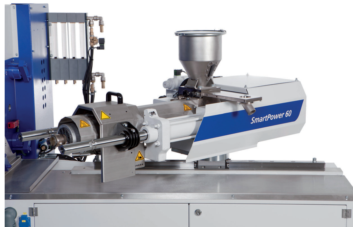
Obr. 4: Otočná vstřikovací jednotka stroje SmartPower pro optimální manipulaci
