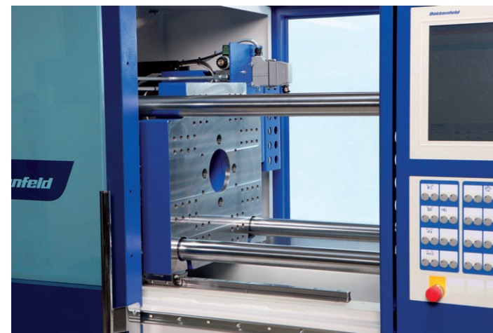
Obr. 3: Prostorná a čistá oblast pro upínání formy (podepření uzavírací desky pomocí lineárního vedení a volných uzavíracích sloupů)
